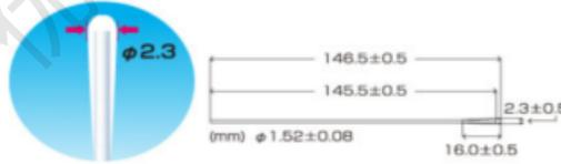
①全长：146.5±0.5mm ④棉端和轴端的距离 D ≥ 1mm
