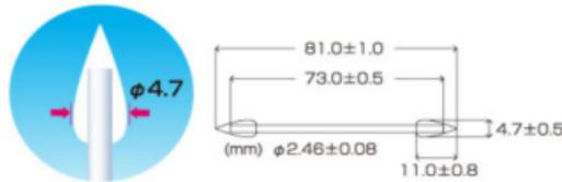
①全长：81.0±1.0mm ④棉端和轴端的距离  $D \geq 1\text{mm}$
