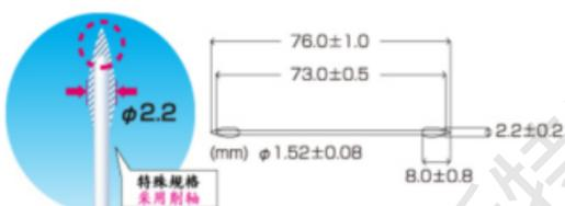
①全长：76.0±1.0mm ④棉端和轴端的距离 D≥1mm
