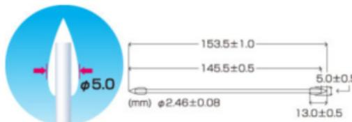
①全长：153.5±1.0mm ④棉端和轴端的距离 D ≥ 1mm
