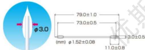
①全长：79.0±1.0mm ④棉端和轴端的距离 D≥1mm
